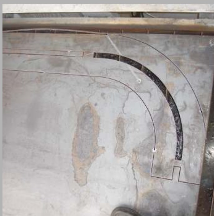
Cortes en lámina HR de 3/8" con velocidad de 1200mm/min. Videos de estos cortes www.youtube.com/cncsystems
