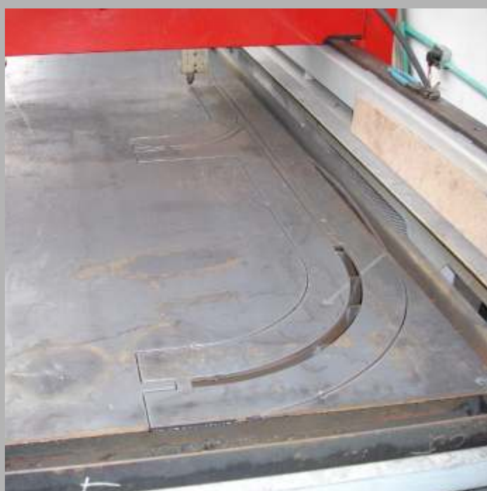
Cortes en lámina HR de 3/8" con velocidad de 1200mm/min. Videos de estos cortes www.youtube.com/cncsystems
